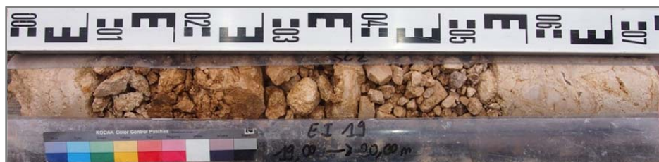
Figure 11- 29 EI-19 du SC2 (19 à 19,75 m). Calcaire beige grisâtre pseudo-brechique concassé.
