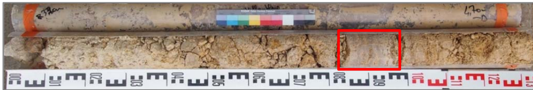
Figure 11- 24 Différents états d'altération dans la roche calcaire micritique. EI-4 du SC1 (3,2 à 4,6 m). Roche dure (rectangle rouge)
