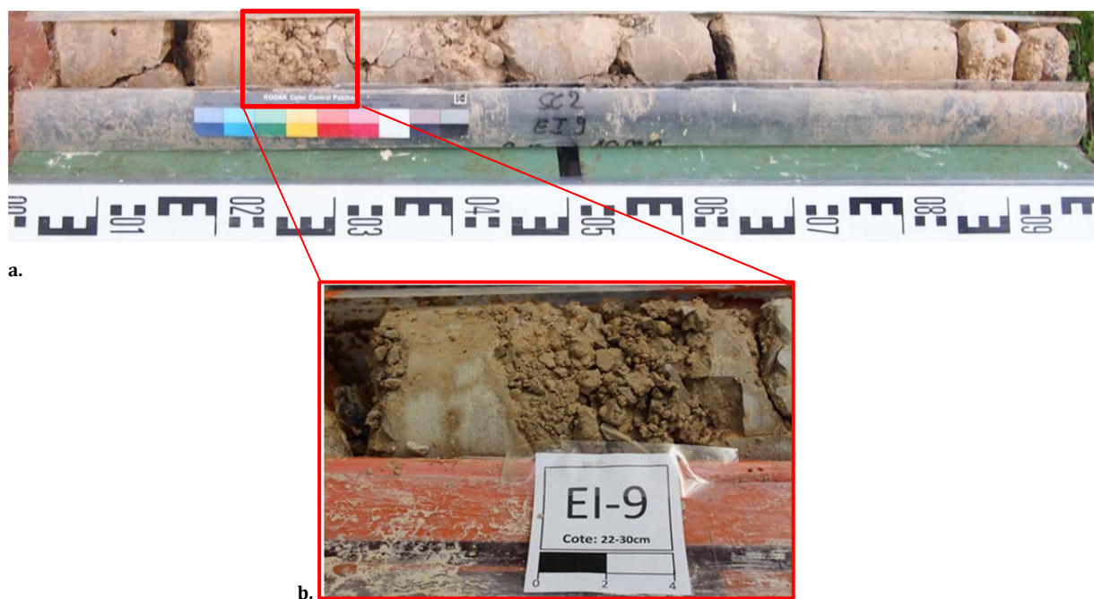
Figure 11- 19 a) Calcaire micritique grisâtre très fracturé, E19-SC2 (9 à 10 m), b) zone d'accumulation et d'altération.
