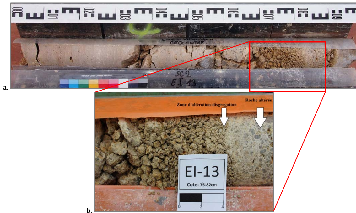
Figure 11- 22 a) EI-13 du SC2 (13 à 14 m) et b) zoom de la zone de désagrégation d'une roche calcaire à 13,8 m de profondeur.
