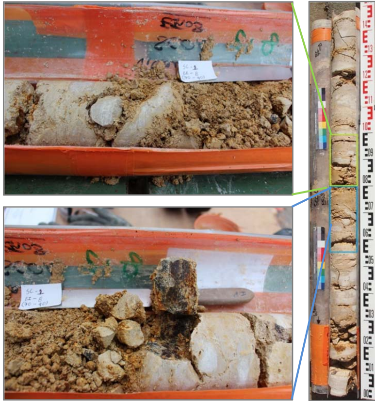
Figure 13- 6 Echantillonnage pour la diffractométrie X sur lame orientée (7,68-7,74 m-SC1).
