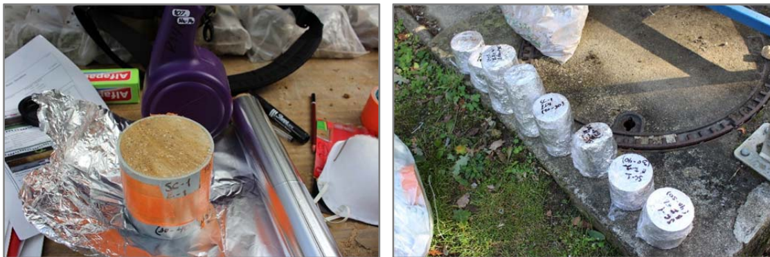
Figure 10- 7 Choix des échantillons pour la mesure des propriétés hydriques et la caractérisation des matériaux.
