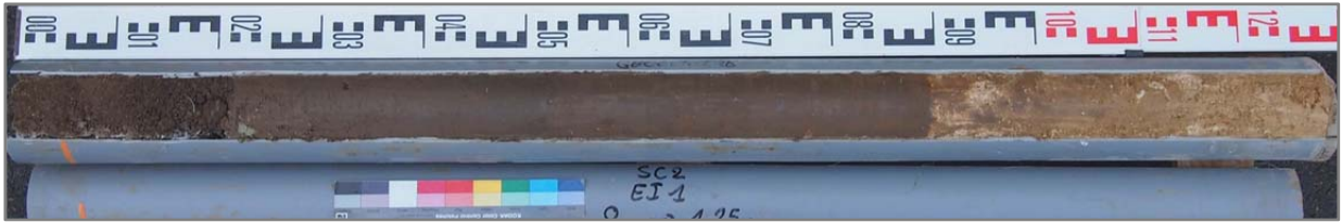
Figure 11- 1 Carotte 1 (EI-1) du sondage carotté 2 (SC2) prélevé entre la surface et 1,25 m de profondeur.
