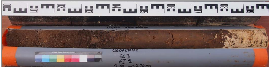
Figure 11- 2 Carotte 2 (EI-2) du sondage carotté 3 (SC3) prélevé entre 1 et 2 m de profondeur.
