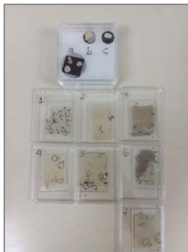
Figure 9- 10 Échantillons observés au MEB. Lames minces après repérage sous microscope optique et métallisation. Échantillons intacts en haut de la figure.
