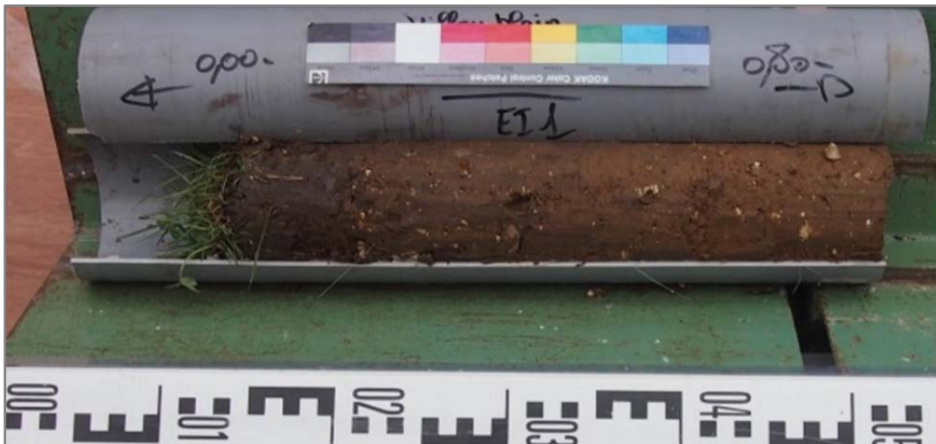
Figure 11- 3 Carotte 1 (EI-1) du sondage carotté 1 (SC1) prélevé entre la surface et 0,4 m de profondeur.
