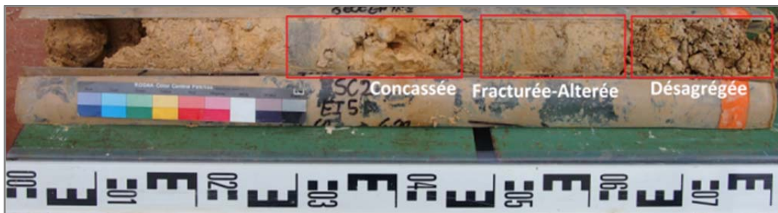
Figure 11- 25 Différents états d'altération dans la roche calcaire micritique. EI-5 du SC2 (4,6 à 5,4 m).
