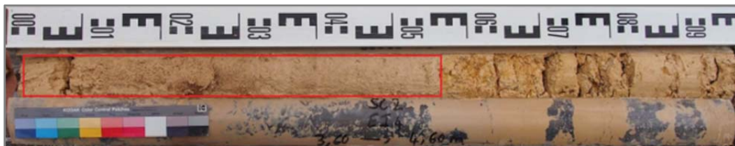
Figure 11- 9 Couche sablo-marneuse (rectangle rouge) du SC2 prélevé entre 3,6 m et 4,6 m de profondeur.
