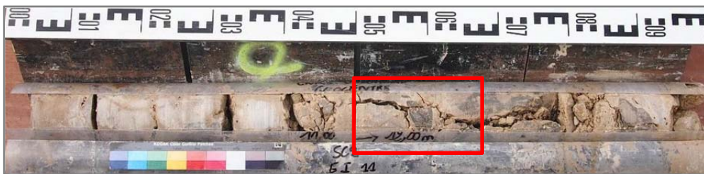
Figure 11- 17 EI-11 du SC2 (11 à 12 m). Le rectangle rouge est une zone de macro-fracturation à 11,5 m de profondeur.
