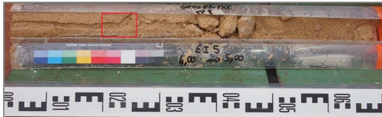
Figure 12- 9 Echantillon de sable prélevé (carré rouge) pour l'analyse granulométrique (prof : 4,2-4,25 m-SC3).
