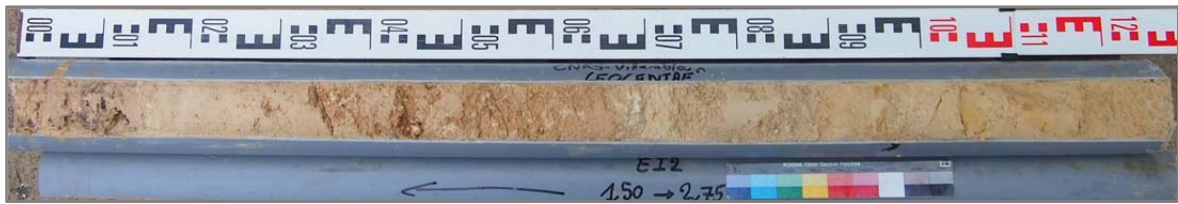
Figure 11- 6 Carotte 2 (EI-2) du sondage carotté 2 (SC2) prélevé entre 1,5 m et surface et 2,75 m de profondeur.
