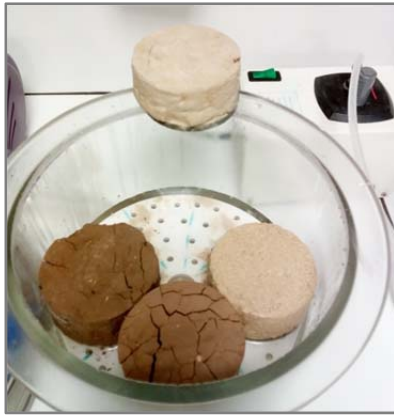
Figure 9- 12 a) Saturation des échantillons cylindriques sous vide dans un cristalliseur, b) saturation des mottes avec un bac à sable.
