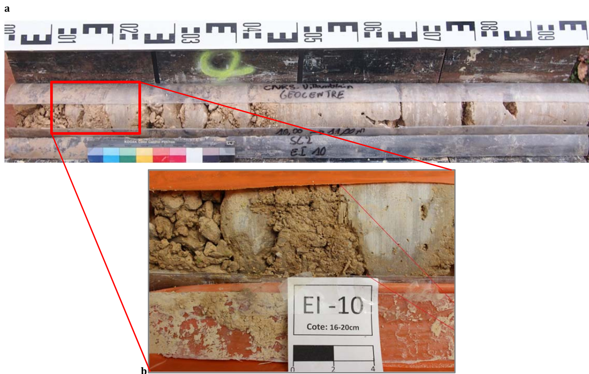
Figure 11- 20 EI-10 du SC2 (10 à 11 m). Roche altérée et fracturée.
