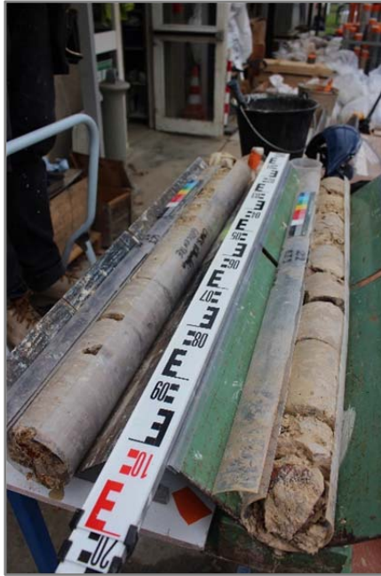
Figure 10- 6 Ouverture de carottes pour la description lithologique.
