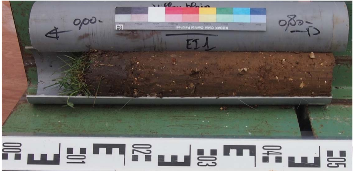
Sondage carotté 1 – échantillon intact 1 (SC1-EI1) : 0 à 0,8 m
