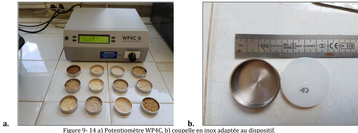
Figure 9- 14 a) Potentiomètre WP4C, b) coupelle en inox adaptée au dispositif.
