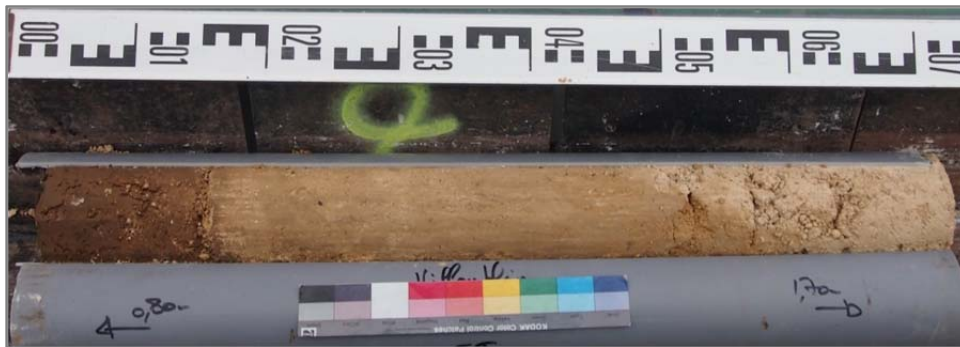
Figure 11- 4 Carotte 1 (EI-1) du sondage carotté 1 (SC1) prélevé entre 0,8 et 1,5 m de profondeur.
