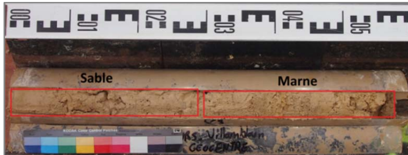
Figure 11- 13 EI-6 du SC3 prélevé entre 5 m et 5,6 m de profondeur. Sable fin (rectangle gauche) et marne (rectangle droit).
