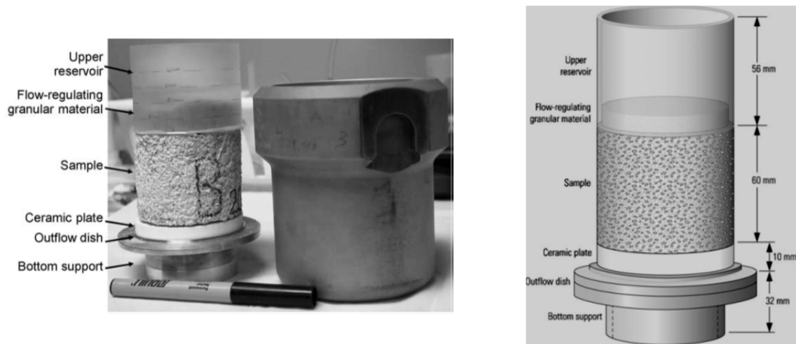
Figure 4- 4 Schéma du montage utilisé pour la méthode de centrifugation (Caputo and Nimmo, 2005)
