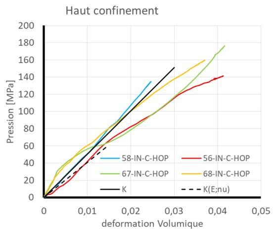
Fig. III-74 : Pression en fonction de la déformation volumique pour les échantillons inerte en haute pression de confinement.
