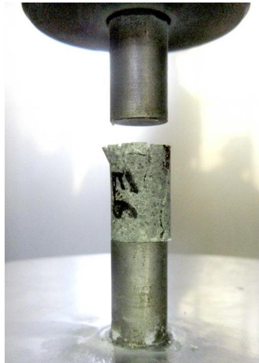
Fig. III-3 : Échantillon E6 après compression non confinée.
