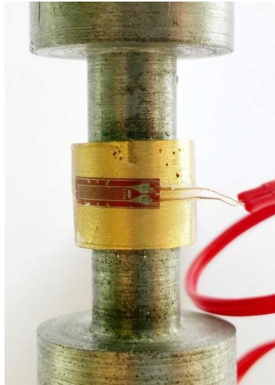
Fig. III-9 : Compression confinée du simulant inerte à l'INSA-CVL
