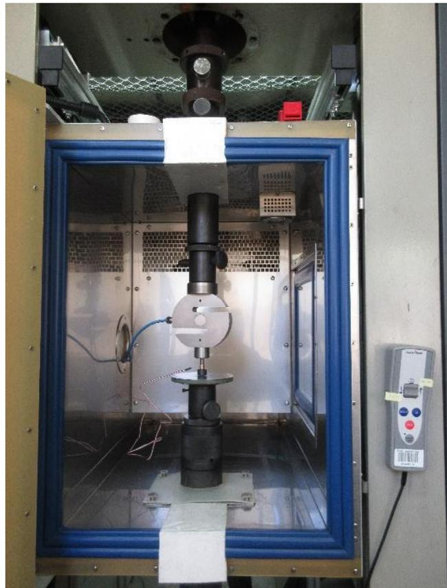
Fig. II-11 : Presse Zwick utilisée à Nexter Munitions.
