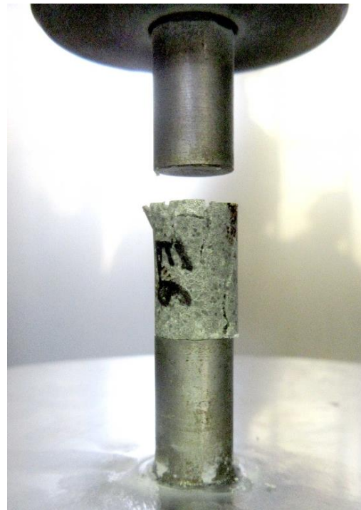
Fig. III-3 : Échantillon E6 après compression non confinée.
