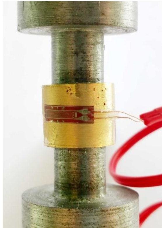
Fig. III-9 : Compression confinée du simulant inerte à l'INSA-CVL
