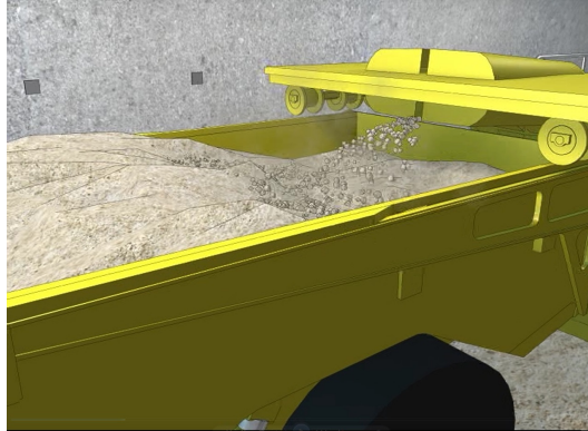
FIGURE 6.11: La sortie des déblais de la MAP
