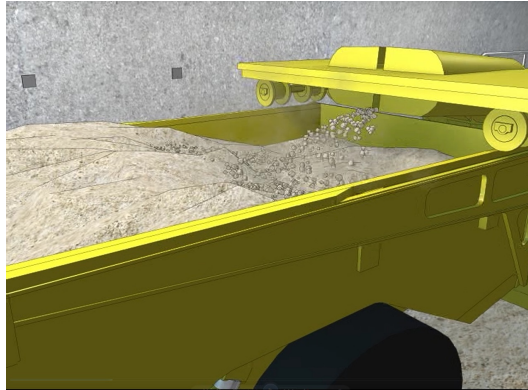
FIGURE 6.11: La sortie des déblais de la MAP
