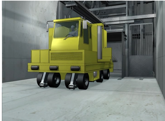
FIGURE 6.24: Le véhicule automoteur utilisé pour les colis MAVL
