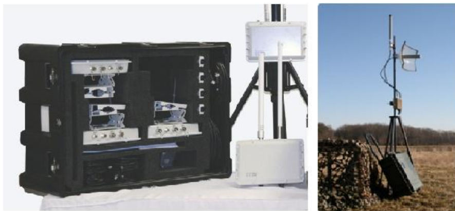
Figure 6: I-STAMS permet de monter rapidement des réseaux mesh dans le domaine militaire (I-STAMS 2013)
