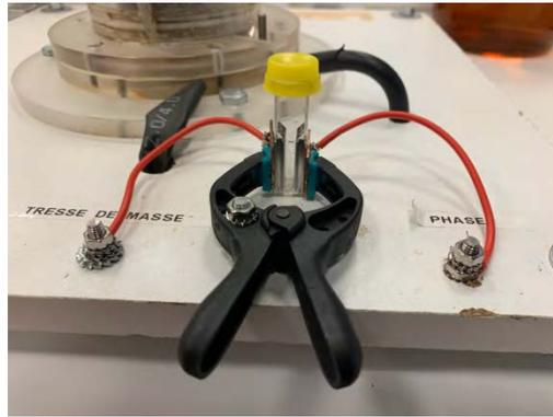
**Figure II-10** Photographie de cuve d'électroporation connectée au système.
