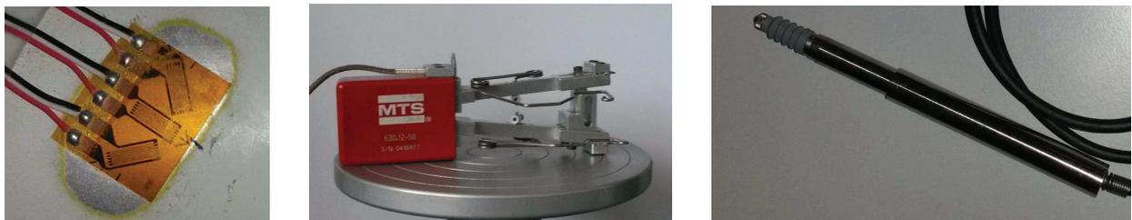
FIGURE 2 – Illustration d'un ensemble de jauges de déformation (à gauche), d'un extensomètre (au centre) et d'un capteur LVDT (à droite).
