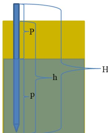
**Figure 2.5 :** schéma représentant les différentes mesures réalisées pour déterminer le niveau topographique relatif de la surface de la nappe d'eau hypodermique. H : hauteur du piézomètre, h : hauteur du technosol, P profondeur de la nappe, p : niveau relatif de la nappe.
