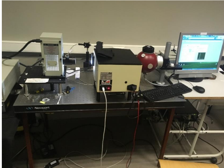
Figure 61 : Banc de mesure de l'efficacité quantique d'un luminophore.
