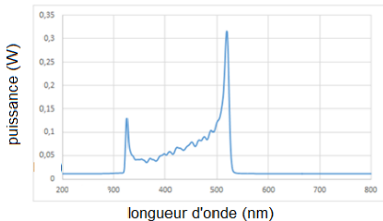
Figure 62 : Puissance spectrale de sortie du laser superK de Fianium.
