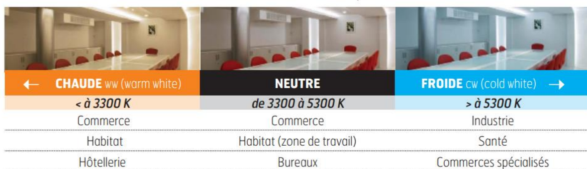
Figure 88 : température de couleurs usuelles dans plusieurs types d'intérieurs [121].
