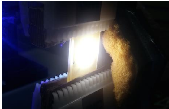
Figure 94 : feuille de luminophore Phosphor Tech 5500K-96 encapsulé dans deux plaques de verre transparentes.
