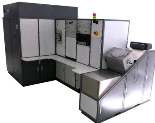
Figure 103 : Implanteur EATON™ NV3206.
