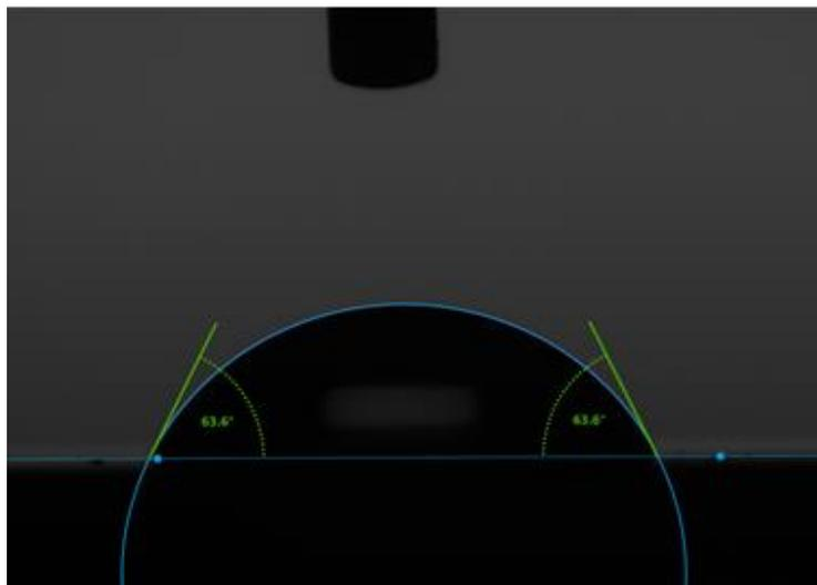
Figure 111 : Mesure de l'angle de contact entre le liquide ( $H_2O$ ) et le substrat (Si implantation  $B^+$  14,8 keV).
