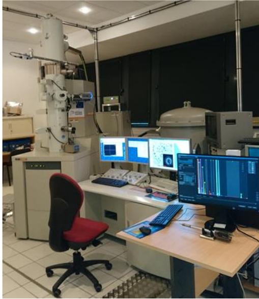
*Figure 44 : Microscope Électronique en Transmission JEOL 2200FS – 200 kV.*
