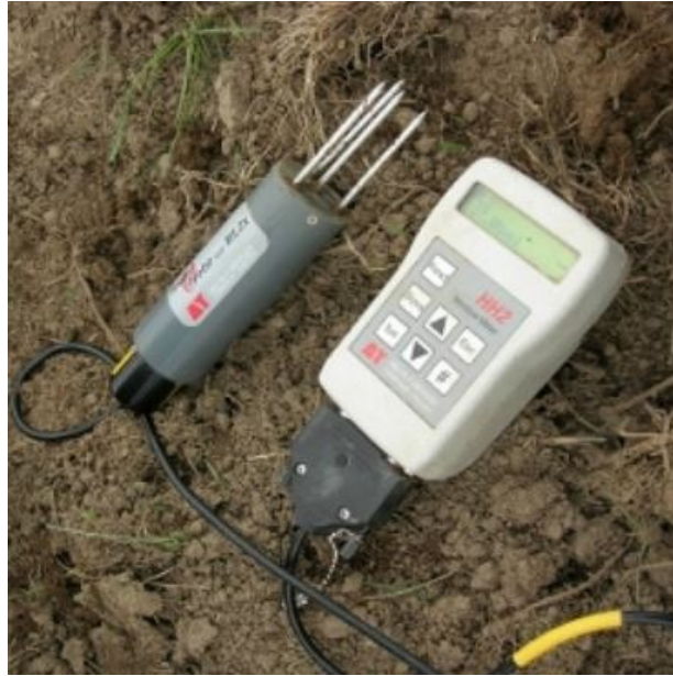
Figure 2. 10 : Un Thetaprobe ML2x pour la mesure de l'humidité du sol
