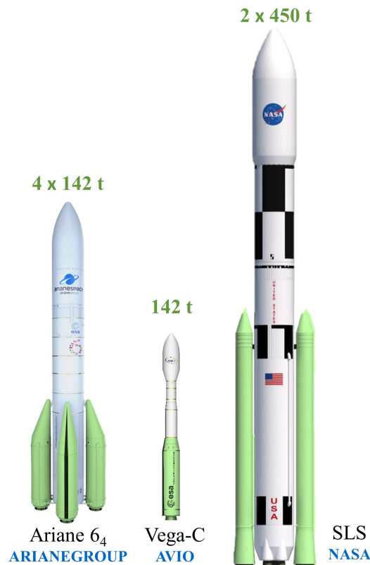
FIGURE 1.1 : Utilisation de la propulsion solide dans la prochaine génération de lanceur spatiaux en Europe comme aux États-Unis (ArianeGroup; NASA, 2019). Les boosters chargés en propergol sont surlignés en vert.
