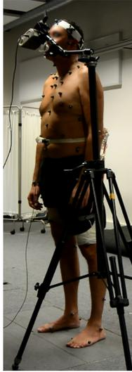
FIGURE B.1 – Sujet respirant à travers un spiromètre
