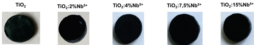
FIGURE 3.10 – Couleur des pastilles après frittage SPS à 960°C.
