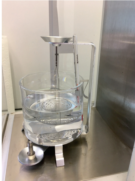
FIGURE 2.5 – Kit de mesure de la masse volumique suivant le principe d'Archimède.
