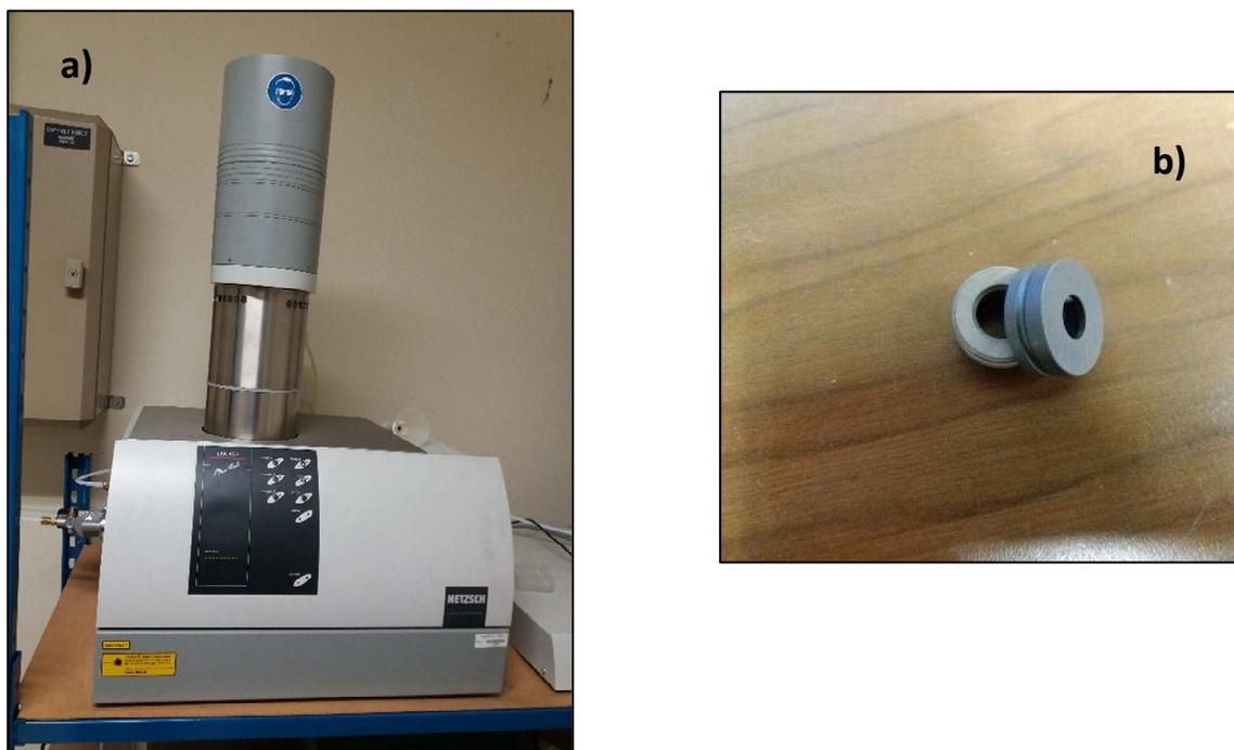
Figure 35: a) Appareil LFA, b) porte-échantillon pour pastille
