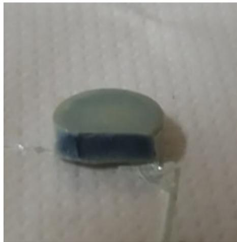
Figure 109 : Pastille de composé  $\text{In}_{1,1}\text{Ga}_{0,9}\text{O}_3(\text{ZnO})_3$
