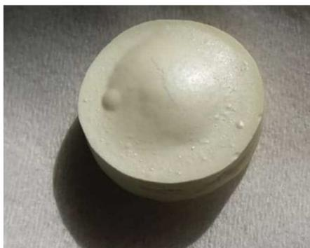
*Figure 81 : Pastille dégradée par volatilisation (bulles apparentes)*
