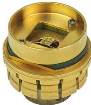
*Figure 39: Porte-échantillon avec plateforme microcalorimétrique pour PPMS*
