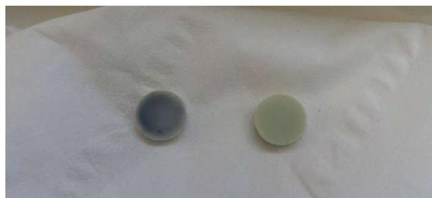
*Figure 53: Pastilles de composés  $\text{InGaO}_3(\text{ZnO})_m$  traitées thermiquement sous air après SPS : gauche 72h 1100°C, droite 168h 1100°C*
