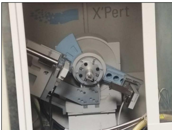
*Figure 27 : Diffractomètre en configuration porte échantillon plat*
