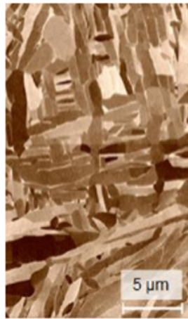
FIGURE 1.11 – Images optiques montrant la microstructure du Ti-6Al-4V après traitement CIC pour des échantillons fabriqués par SLM [11].
