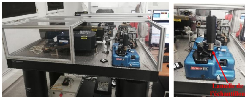
Figure 14 : Montage du microscope à force atomique de l'ICP. À gauche : vue générale de l'appareil nanoIRTM (@Ansys Instruments). À droite : Position de l'échantillon au-dessus du levier.
