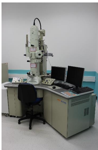
Figure 15 : Montage du microscope électronique à transmission MET STEM JEOL 1400 au laboratoire du CNRS de GIF- sur-Yvette.
