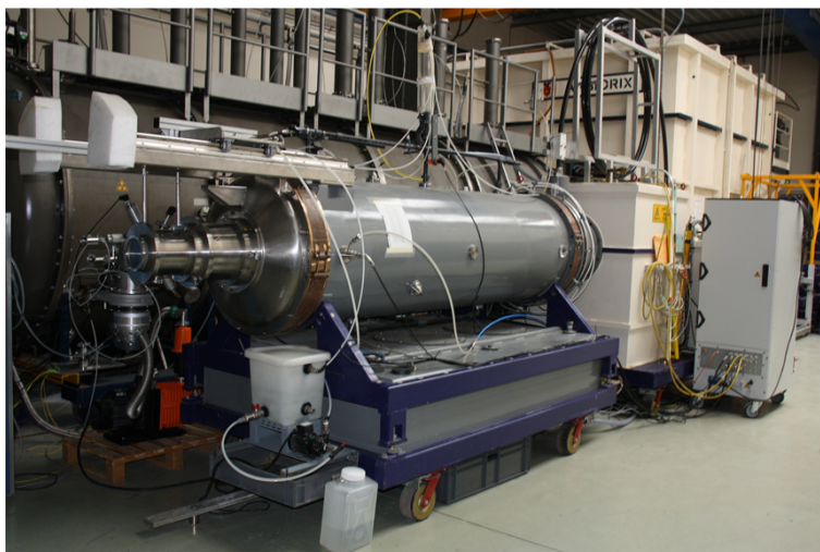
FIGURE 10 – Photographie du générateur RKA.
