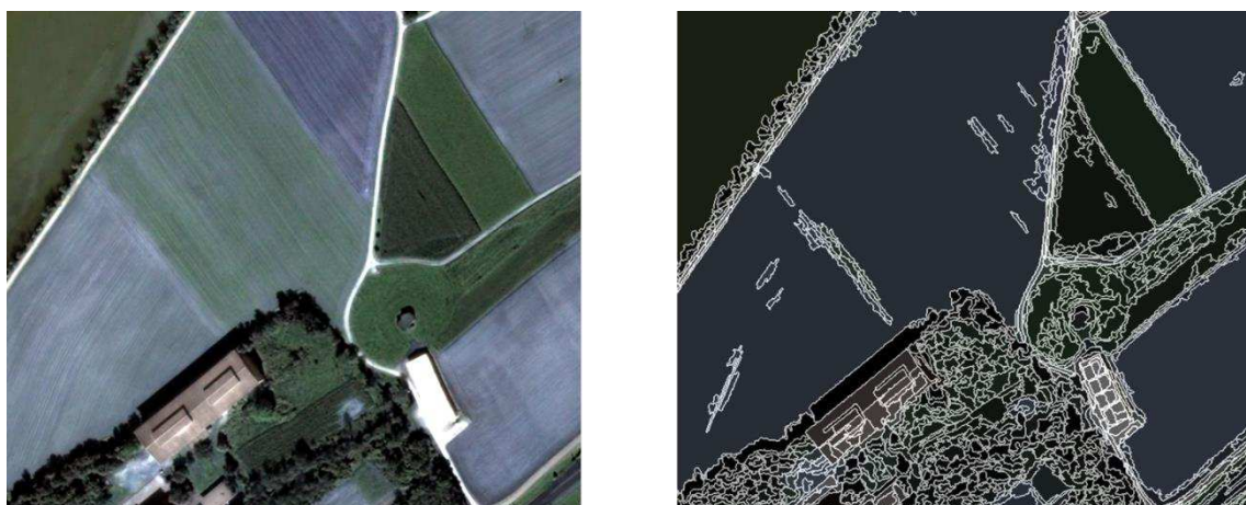
Figure 2.9 : Segmentation réalisée par Mean Shift à partir des réflectances acquises dans le visible (d'après Inglada, 2015).
