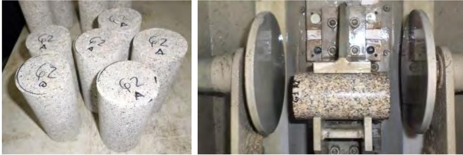
Figure 56 Préparation des éprouvettes cylindriques, carottage et rectification
