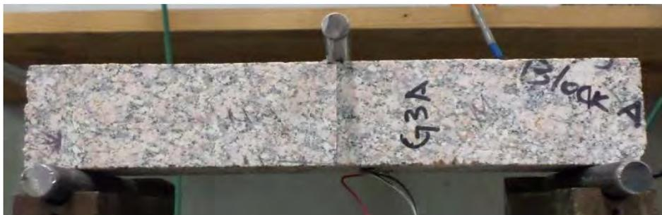
Figure 63 Disposition de l'essai en flexion
