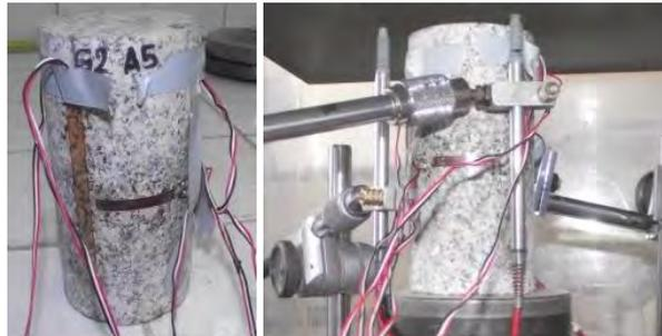
Figure 58 Eprouvettes cylindriques du granite, jauges verticale et horizontale et capteurs LVDT pour contrôle de l'essai
