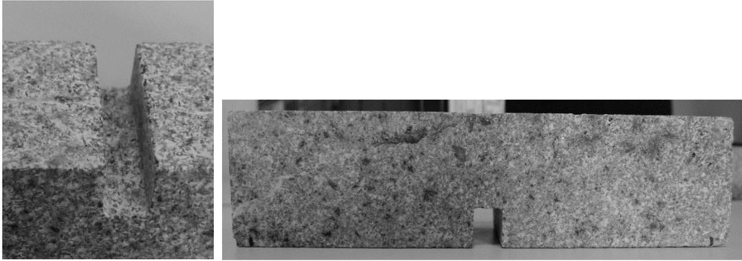
Figure 42 Entaille sur des échantillons en flexion
