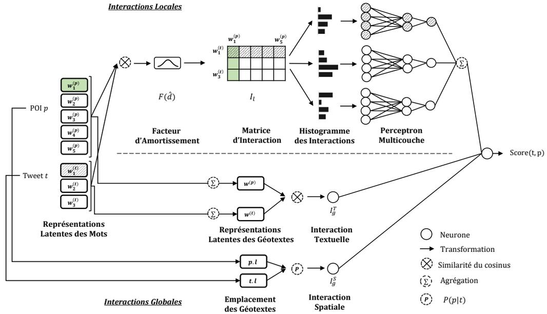
Figure 5.3 – Architecture du modèle **SGM**. La case verte correspond au 1<sup>er</sup> mot du POI  $p$ . La case hachurée correspond au 1<sup>er</sup> mot du tweet  $t$ .
