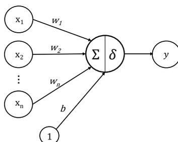
Figure 3.1 – Exemple d'un neurone formel : le perceptron.
