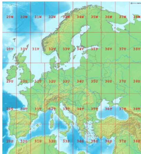
Figure 2.4 – Coordonnées des pays Européens dans le système UTM. (©Wikimedia)
