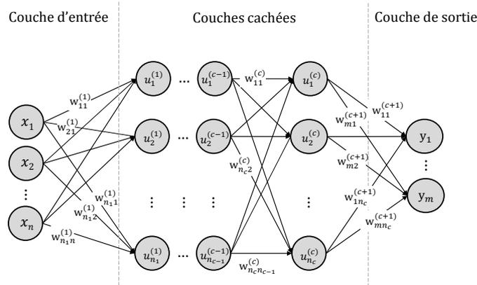
Figure 3.3 – Architecture d'un perceptron multicouche.
