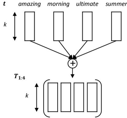
Figure 5.4 – Illustration de la matrice de représentation d’un tweet composé de quatre mots et de vecteurs distribués de dimension  $k$ .
