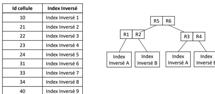
Figure 2.9 – Exemple d'un index primaire spatial avec une décomposition de l'espace en grilles (à gauche) et un R-arbre (à droite).
