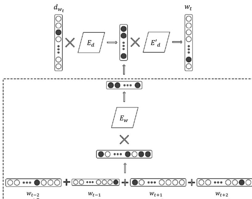
Figure 3.8 – Architecture du modèle *ParagraphVector* ([Le et Mikolov, 2014](#)). Le modèle PV-DBOW est entraîné à prédire un mot en tenant compte du document qui contient ce mot. Dans la variante PV-DM (zone en pointillée), les mots voisins sont aussi fournis comme données d'entrée. (©[Mittra et Craswell \(2018\)](#))
