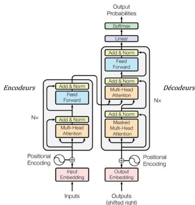
Figure 3.6 – Architecture générale d'un *transformer* (Vaswani *et al.*, 2017).
