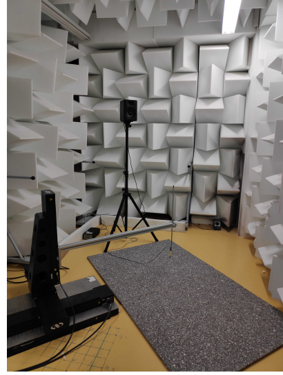
Figure 6.40 Configuration de mesure, microphone fixé à un robot de déplacement 3 axes, a = 7 cm, source monopolaire à r_l = 1.78 m, \phi_m = 30^\circ , au dessus d'une mousse d'épaisseur 25 mm. La ligne violette symbolise la limite de l'ordre m = 2 avant le bruit de fond
