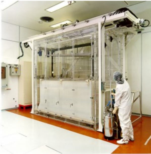
Photo 20 : Installation de dip-coating dit également trempage retraits avec une cuve de solvant de 400 litres.
