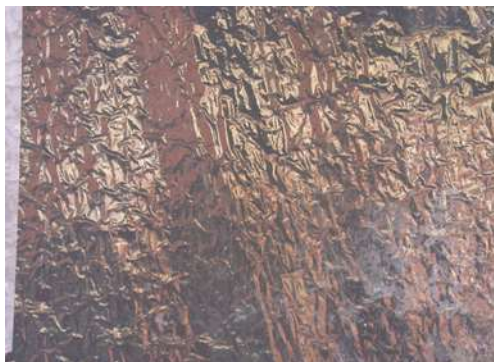
Photo 16 : Aspect d'un film magnétique sur support souple après traitement thermique.
