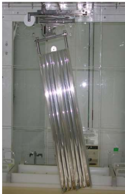
Photo 23 : Image du réflecteur latéral argenté par galvanoplastie, ici, lors d'un dépôt de protection sol-gel.
