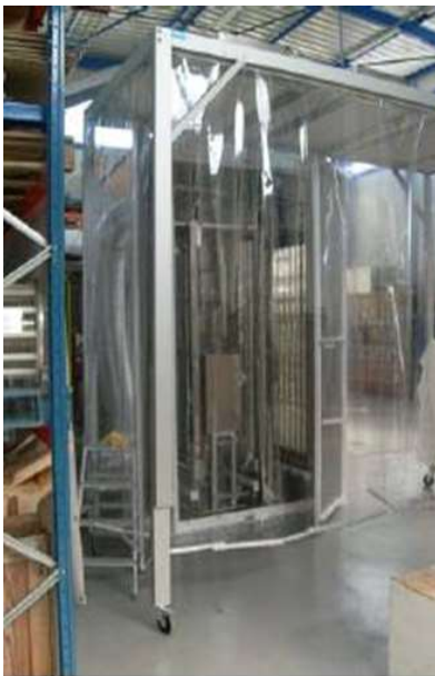
Photo 26 : Banc de l'ITHPP placé sous un plafond soufflant (ISO 6).
