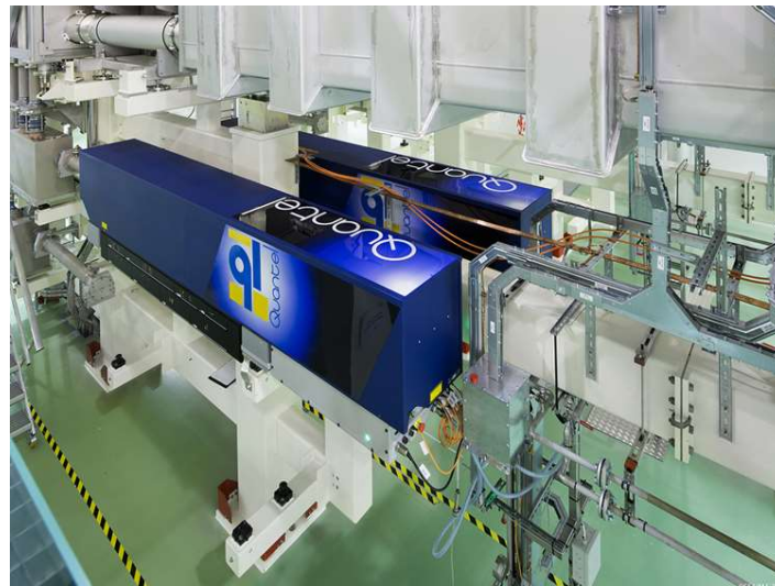
Figure 9 : Mise sur chaîne des 2 premiers MPA (Module Préamplificateur) du pilote du LMJ [11].
