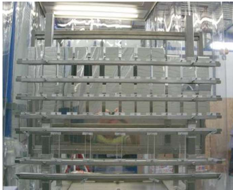
Photo 27 : Batterie d'échantillons dont des réflecteurs qui vont subir des tests flashes sur le banc ITHPP (éclairage de 1 kW/cm 2 ).
