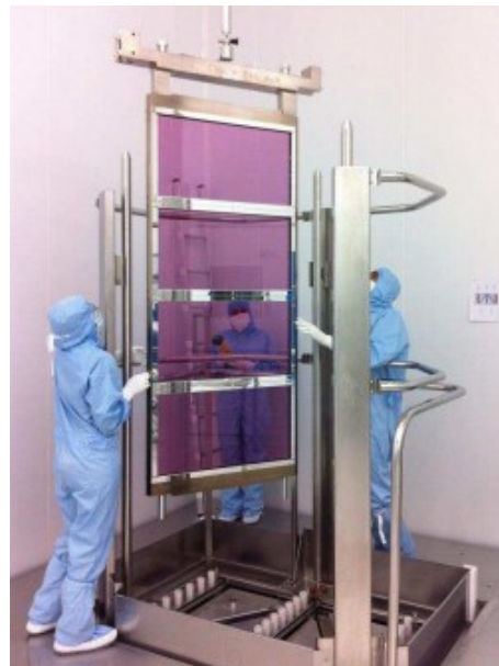
Figure 16 : Montage d'une URL (Unité Remplaçable en Ligne) de 4 plaques de verre laser au néodyme qui seront pompées par une batterie de lampes flashes [11].
