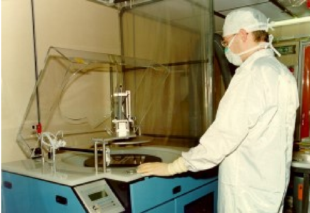
Photo 6 : Poste de travail d'un spin-coating dans un environnement propre.
