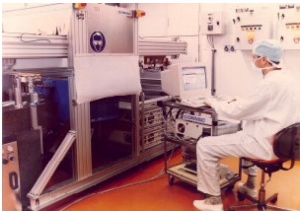
Photo 21 : Installation d'enduction laminaire dit MELI (Machine d'Enduction Laminaire Industrielle).
