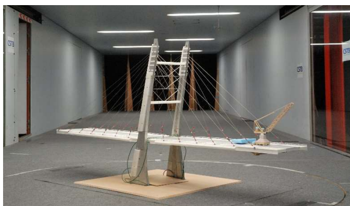
Figure 57. La maquette aérodynamique du pont de Korabelny à Saint-Petersbourg en construction, © CSTB
