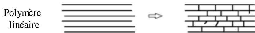
Schéma I.5 : Impact de la réticulation de chaînes sur l'architecture des polymères [11].
