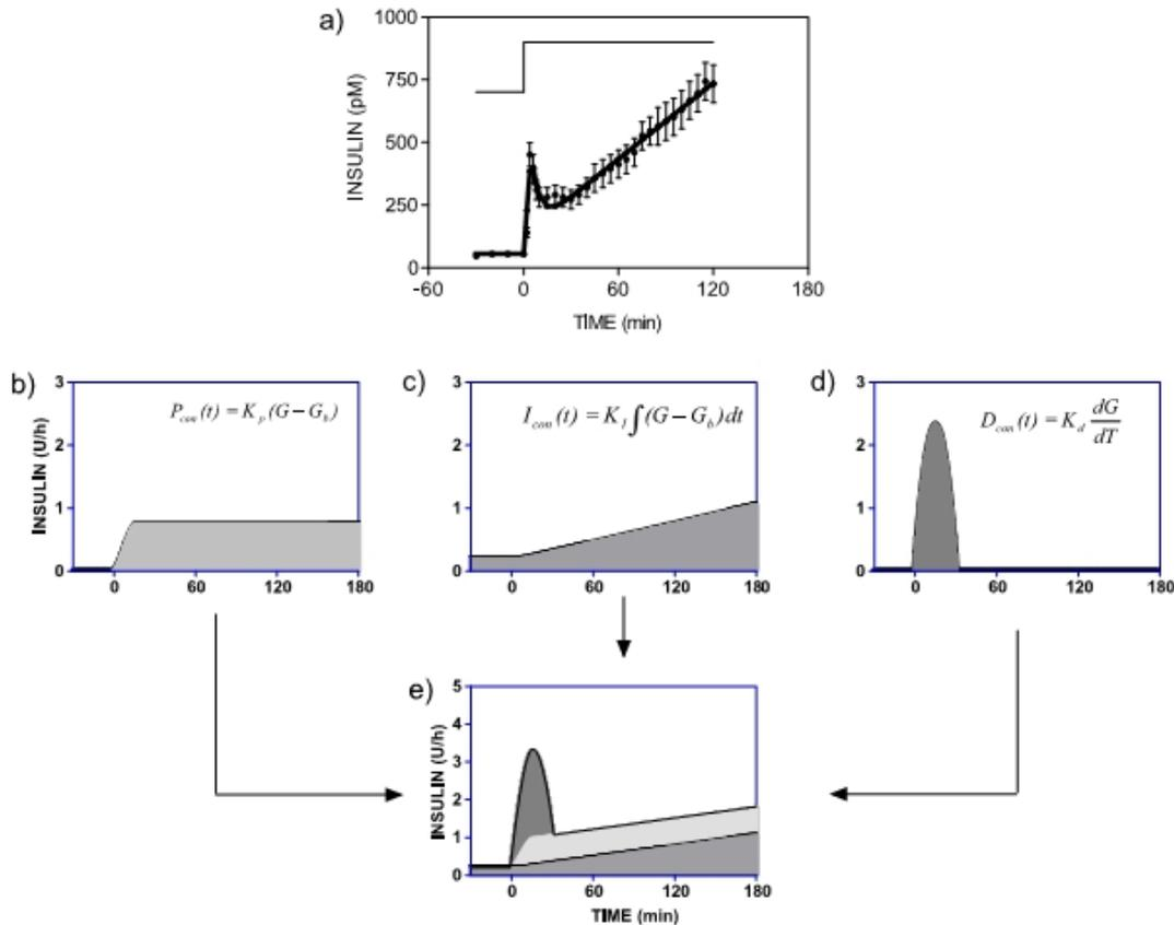
a) Réponse des cellules  $\beta$  (cercles) et d'un PID (trait plein) ; b), c) et d) actions proportionnelle, intégrale et dérivée pour une erreur constante. e) Somme des actions P, I et D. Illustration tirée de [86]
