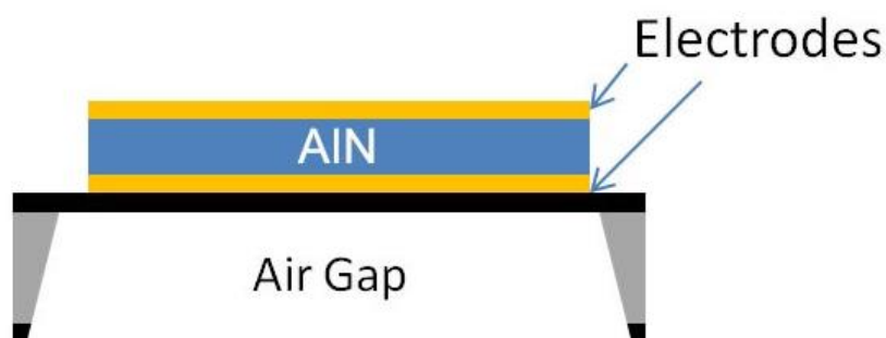
Figure 1.19 : Résonateur acoustique en volume à film mince (Thin Film Bulk Acoustic Resonator)
