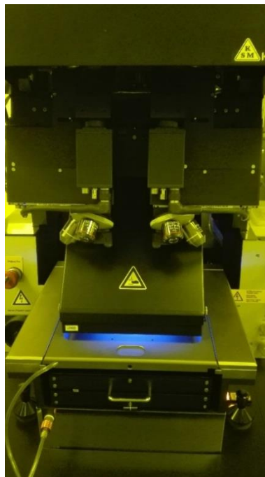
Figure 2.15 : Insolation de la résine à travers le masque à l'aide de MA6/BA6
