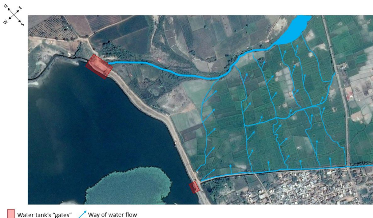
Figure : exemple d'observation de paysage sur le territoire de Vinukonda : fonctionnement d'un réseau de micro-canaux d'irrigation dans des rizières présentes sous un réservoir d'eau.
