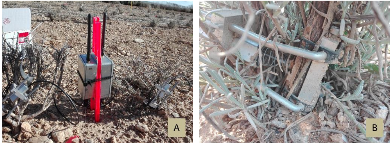
Figure 45. Photos des PépiPIAFs installés sur la parcelle du Criepmam sur la modalité sol nu.
