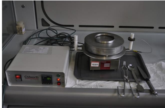
Figure II.4 - plaque circulaire chauffée électriquement (Danzi et al. 2015)
