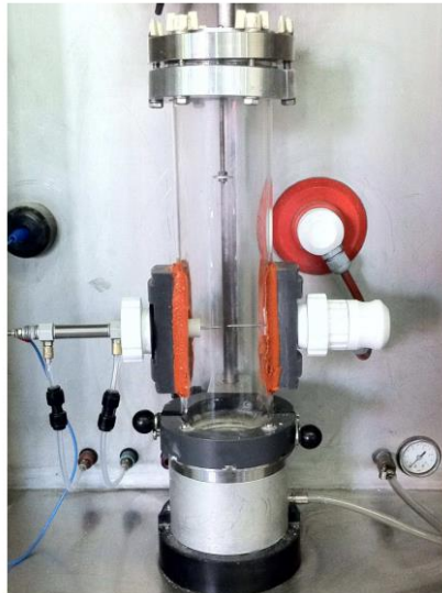
Figure II.3 - Tube de Hartmann modifié de type Mike 3 (Khalili, 2012)
