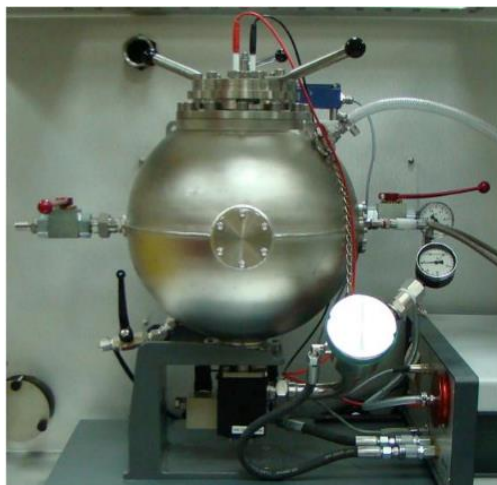
Figure III.44 - Sphère de 20 L Kühner du standard et allumage pyrotechnique
