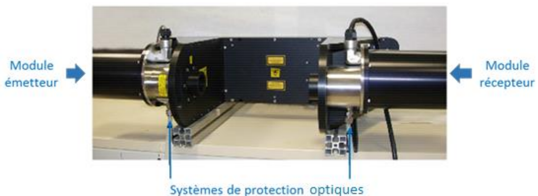
Figure III.20 - Photo du granulomètre laser Malvern (Baudry, 2007)
