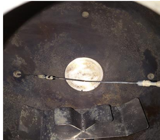
Figure III.43 - Sphère de 20 L utilisée et allumage électrique
