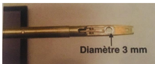
Figure III.53 - Grille de 3 mm pour analyse au MET
