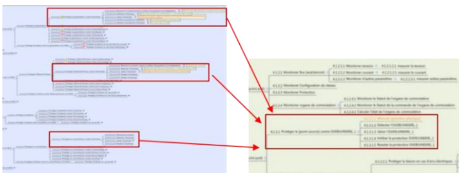
Figure 38. Exemple d'une fonction répétée (à gauche) et de sa factorisation (à droite)
