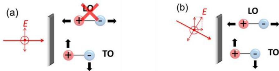
Figure II-6 : Représentation schématique de la réponse des modes de vibrations LO et TO en fonction de l'angle du faisceau incident [199].
