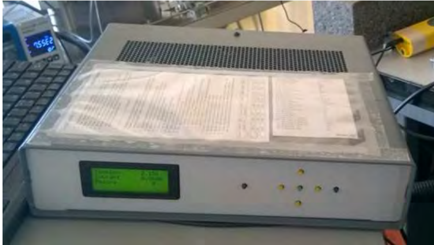
Fig. III-6. Boîtier Langmuir V1 utilisé pour appliquer le potentiel V_s à notre sonde de Langmuir et récupérer la courbe caractéristique I-V.
