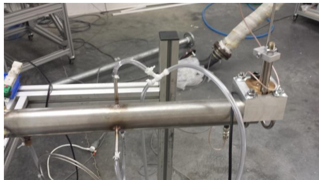
Figure 65 – Position du film chaud sur le banc papillon
