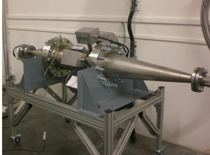
Figure 20 – Réchauffeur électrique du banc papillon
