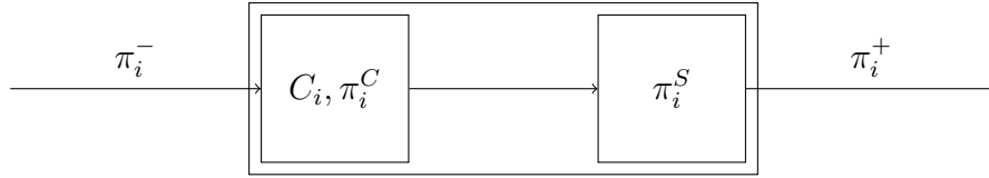
FIGURE 3.10 – Définition schématique d'un étage de filtrage (avec un FIR à gauche et un décalage logique à droite)
