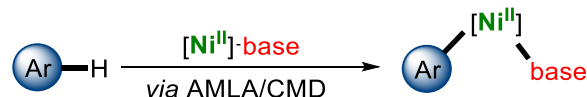
Schéma 10. Activation C–H d'un substrat aromatique par le Ni(II) via un mécanisme de type CMD.
