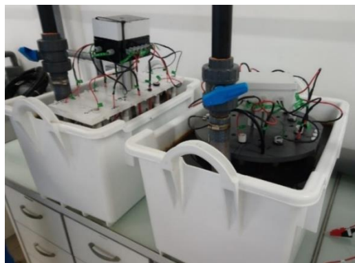
Figure A-4 : Bacs contenant les montages de mise en conditions de protection cathodique.
