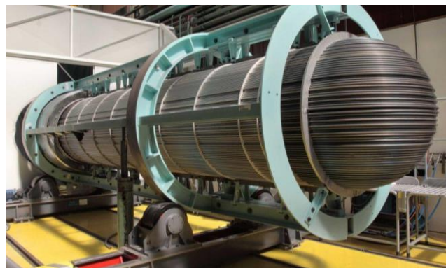
Figure 0-1 : Tubes d'échangeur thermique en titane.
