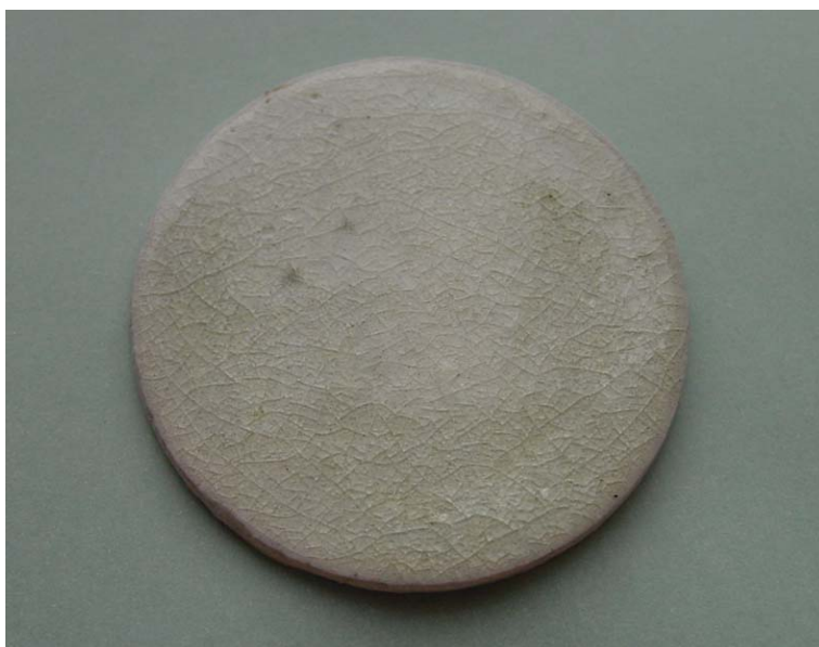
Figure 25: Traitement des Fissures esthétique , créé par un choc thermique à 1100°C.
