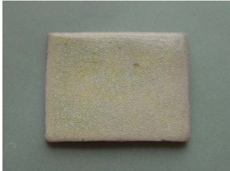
Figure 24: Traitement des Fissures esthétique , créé par un choc thermique à 900 ° C.
