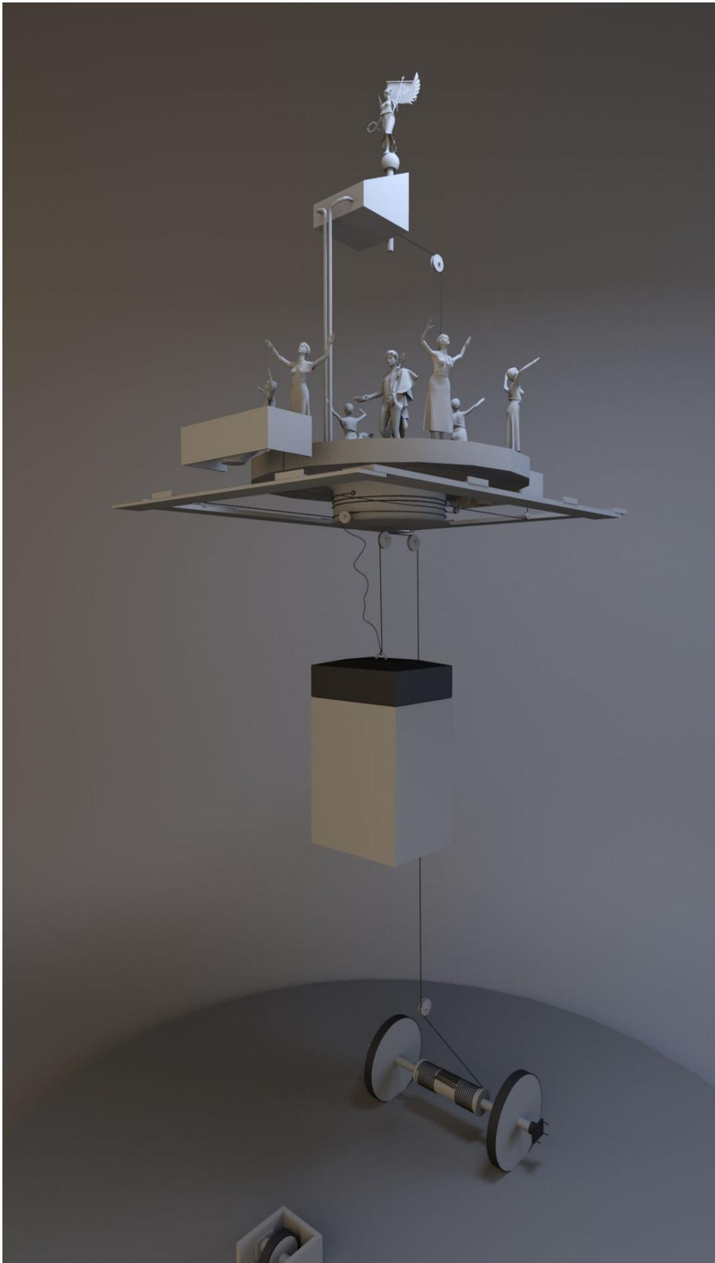
FIGURE 56 – Vue générale du mécanisme interne du théâtre automatique à base mobile d'Héron d'Alexandrie (Réalisation J. Nicolle).
