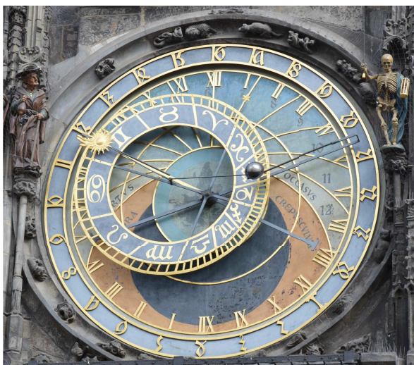
Figure 10 - Horloge astronomique de l'Hôtel de ville de Prague (République Tchèque). Vers 1410. Cette horloge possède de nombreuses fonctions : - L'heure locale, désignée par la main dorée sur les chiffres romains. - L'heure en douzièmes de jour, désignée par la position du Soleil sur les courbes dorées. - L'heure en anciennes heures tchèques, désignée par la main dorée sur les chiffres gothiques. - La position du Soleil dans le ciel. - La position de la Lune dans le ciel ainsi que sa phase. - Le signe astrologique zodiacal dans lequel on est (ainsi que le décan). - Le temps sidéral, indiqué par la petite étoile dorée.
