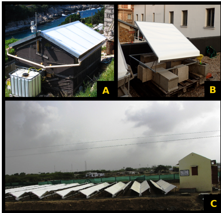
FIGURE 1.5 – A : Condenseur de type "sur toiture", Bisevo, Croatie, tiré de Clus (2007). B : condenseur plan incliné de 30^\circ par rapport à l'horizontale, Paris, France. C : Usine de rosée de Kothara, Kothara, Inde. D'après Sharan et al. (2016) [93]
