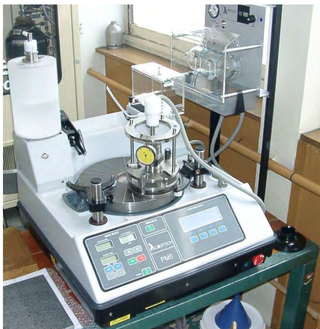
Figure II. 13 : Image montrant la polisseuse de précision LOGITECH PM5.
