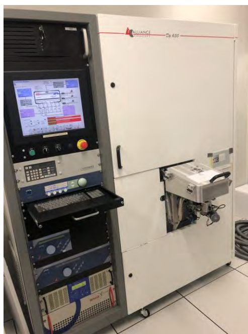
Figure II. 28 : Bâti de pulvérisation cathodique Alliance DP 650.
