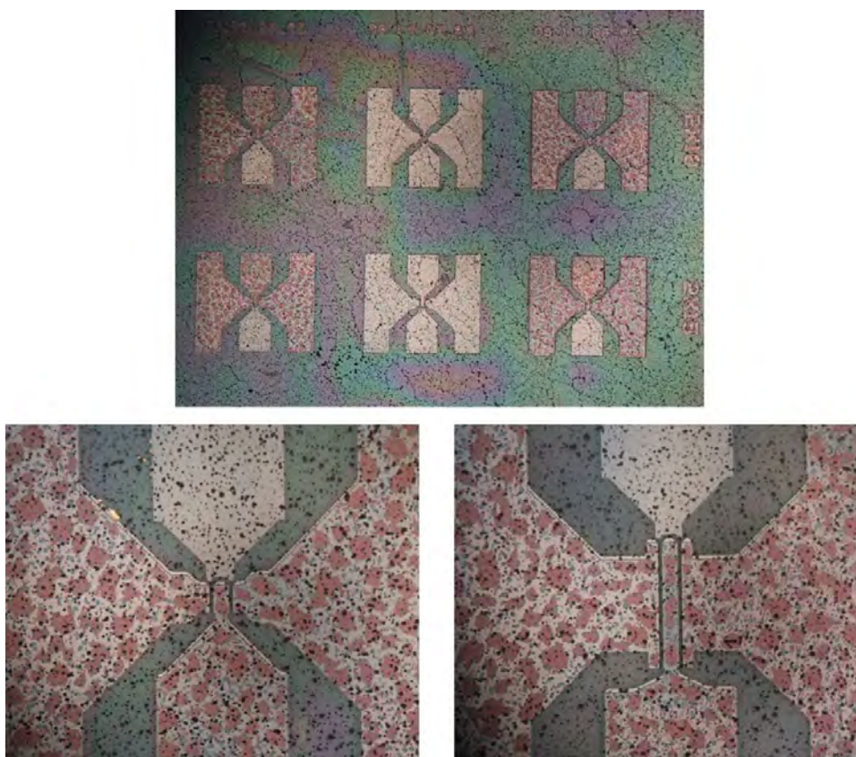
Figure II. 22 : Images optiques de la face arrière de l'échantillon après dépôt de 450 nm d'AlN.
