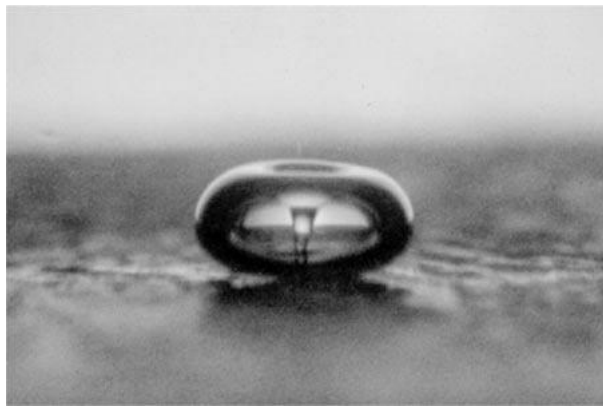
Figure I-26. Formation de micro-jet lors de l'implosion d'une bulle de cavitation ( \varnothing_{\max \text{ bulle}} \approx 2 \text{ mm} ) oscillante dans un champ acoustique de 60 Hz [182]
