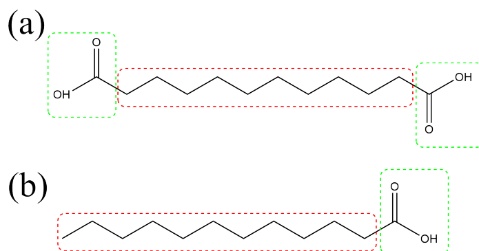
Fig. 2.1 – Structures moléculaires de l'acide dodécanedioïque (DDA) (a) et de l'acide dodécanoïque (DA) (b). Les parties polaires sont représentées en vert et les parties apolaires en rouge.
