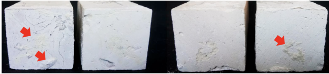
FIGURE 1.17 – Arrachement de pierre lors d’un essai de flexion 4 points sur prismes (Karatasios et al., 2018)
